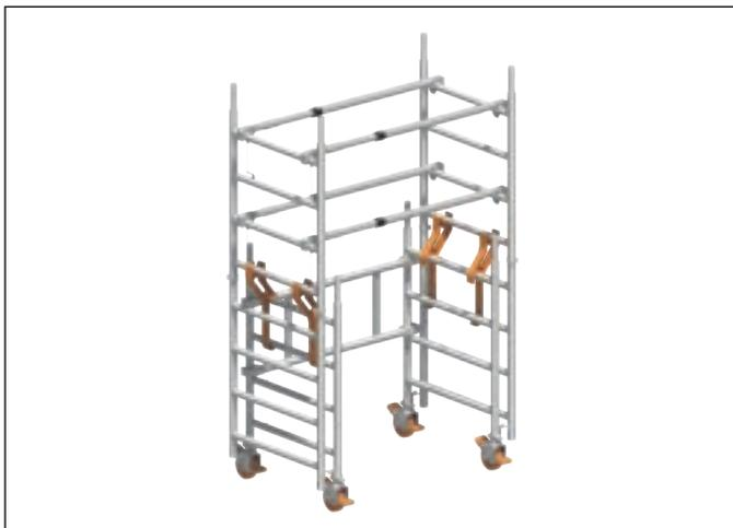
4. Montage der Durchstiegsbrücke an der 5. Sprosse von oben der beiden Standleitern. Aufsteigen auf die nun gesicherte Lage und arretieren der teleskopierbaren Geländer mittels der befestigten Federstecker.
