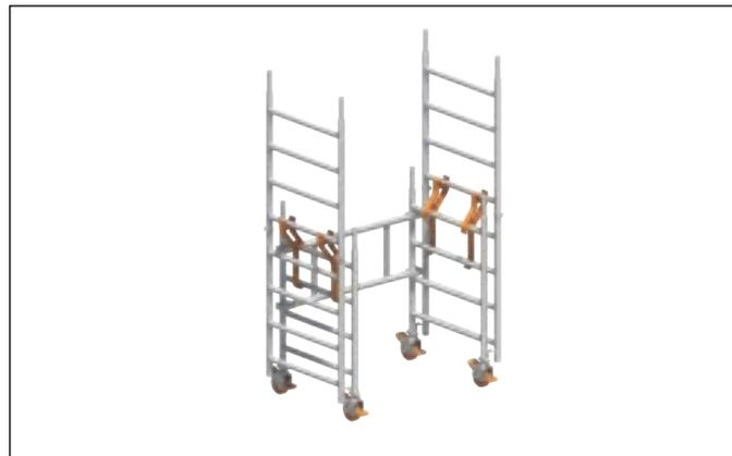
2. Montage der 4 teleskopierbaren Geländer **2** jeweils an der obersten Sprosse und der 3. Sprosse von oben, an den zuvor positionierten Standleitereinheiten.
