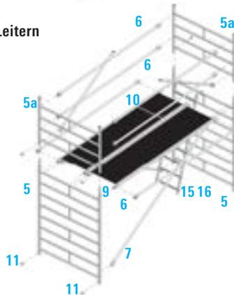
Die Rückenlehnen 6 und Diagonalen 7 sind nach dem Einbau soweit wie möglich nach außen zu schieben.
