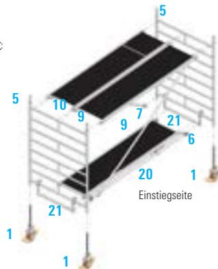
1. Die Lenkrollen **1** in die Standleitern **5** einstecken und durch Festdrehen der Flügelschrauben an den Spindelmuttern gegen Herausfallen sichern.
