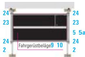
Abstandsrohr **23** verwendet und mit Kupplungen **24** an der Standleiter **5, 5a** befestigt. Die Fahrbalken sind so einzubauen, dass sie an der wandabgewandten Seite auskragen. Die Wandabstützungen sind in Höhe der obersten Arbeitsbühne oder höchstens 1 m tiefer anzubringen.
