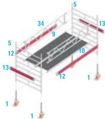
1. Die Lenkrollen **1** werden beim Gerüst 2201 in die Standleitern **5** eingesteckt und durch Festdrehen der Flügelschrauben an den Spindelmuttern gegen Herausfallen gesichert.
