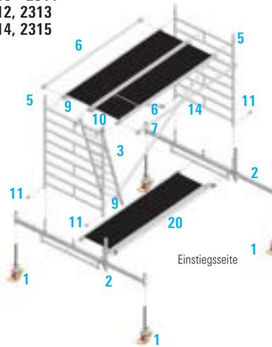
1. Die Lenkrollen **1** in den Fahrbalken **2** einstecken und durch Festdrehen der Flügelschrauben an den Spindelmuttern gegen Herausfallen sichern.
