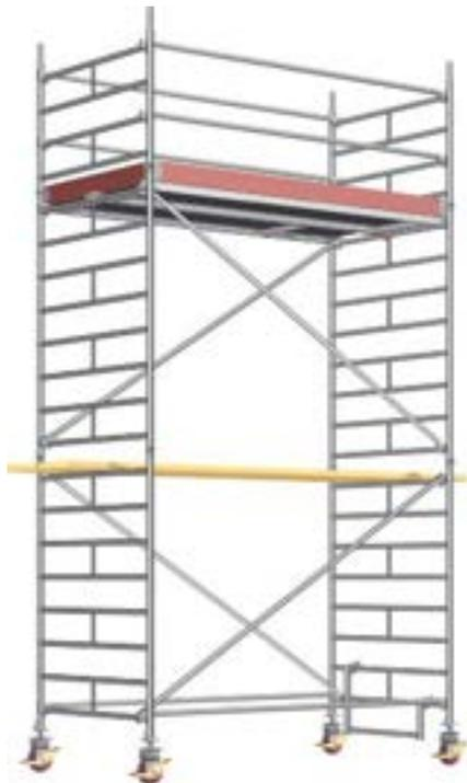
Es müssen beim Aufbau und Abbau Systembeläge oder Gerüstbohlen nach DIN 4420-3 (Mindestabmessung: 28 x 4,5 x 350 cm lang) als Hilfsbeläge im Höhenabstand von max. 2,0 m eingebaut werden. Diese Hilfsbeläge, als sichere Standfläche für den Auf- und Abbau, müssen nach dem Aufbau wieder ausgebaut werden. Die jeweilige Standfläche ist voll auszulegen.
