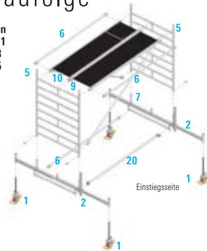
1. Die Lenkrollen **1** in den Fahrbalken **2** einstecken und durch Festdrehen der Flügelschrauben an den Spindelmuttern gegen Herausfallen sichern.
