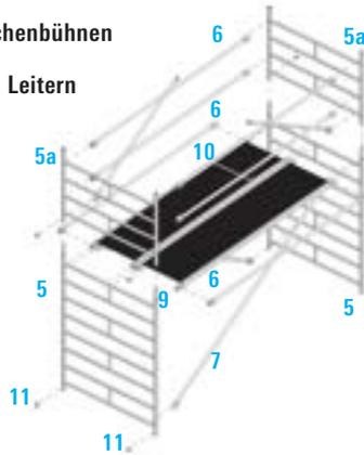
Es müssen beim Aufbau und Abbau Systembeläge oder Gerüstbohlen nach DIN 4420 (Mindestabmessung: 28 x 4,5 x 350 cm lang) als Hilfsbeläge im Höhenabstand von max. 2,0 m eingebaut werden. Diese Hilfsbeläge, als sichere Standfläche für den Auf- und Abbau, müssen nach dem Aufbau wieder ausgebaut werden. Die jeweilige Standfläche ist voll auszulegen.
