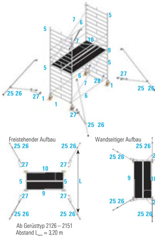
Die Lenkrollen **1** werden in die Standleitern **5** eingesteckt und durch Festdrehen der Flügelschrauben an den Spindelmuttern gegen Herausfallen gesichert. An die Standleiter **5** einen Aufstiegsbügel **28** mittig anschrauben.
