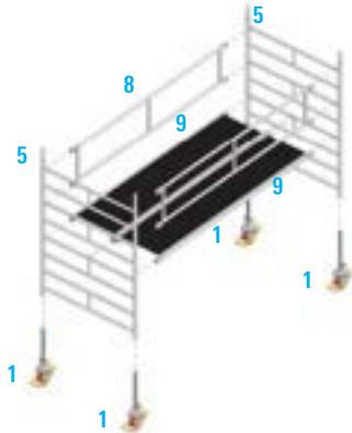
1. Die Lenkrollen **1** werden beim Gerüst 2101 in die Standleitern **5** eingesteckt und durch Festdrehen der Flügelschrauben an den Spindelmuttern gegen Herausfallen gesichert.
