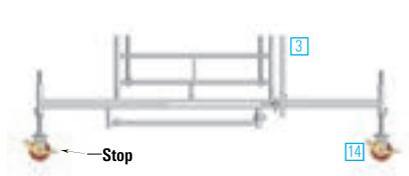
Maximaler Höhenausgleich (Spindelweg) ohne Belag an der Fußspindel = 15 cm
