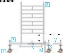
Der verstellbare Fahrballen **2** ermöglicht das Arbeiten an der Wand. Er kann im aufgebauten Zustand ein- und ausgeschoben werden. Es ist zu beachten, dass vor dem Verstellen auf jeden Fall die in der Ballastierungstabelle angegebenen Ballastgewichte an der richtigen Stelle angebracht sind (siehe Seite 7). Zum Verstellen im aufgebauten Zustand wird die am Fahrballen **2** angebrachte Mittelstütze (M) soweit wie möglich abgelassen und gesichert.
