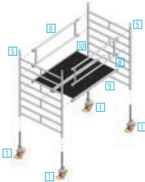
1. Die Lenkrollen **1** werden beim Gerüst 5001 in die Standleitern **5** eingesteckt und durch Festdrehen der Flügelschrauben an den Spindelmuttern gegen Herausfallen gesichert.
