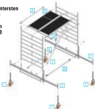
1. Die Lenkrollen **1** in den Fahralken **2** einstecken und durch Festdrehen der Flügelschrauben an den Spindelmuttern gegen Herausfallen sichern.
