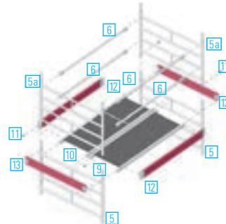
Nach dem Aufstecken der obersten Standleitern **5** oder **5a** und Sichern mit Federsteckern **11** wird in die von oben 5. Sprosse eine Durchstiegsbrücke **10** und eine Belagbrücke **9** eingehängt. Herstellen des vorschriftsmäßigen Seitenschutzes je nach Gerüsttyp durch den Einbau von 2 Doppelrückenlehnen **8** oder 4 Rückenlehnen **6** einstellen und durch Einfügen von 2 Stirnbordbrettern 1,44 m **13** sichern.
