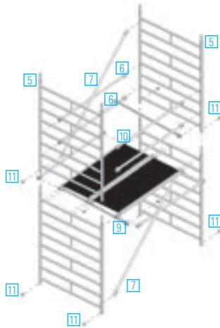
Es müssen beim Aufbau und Abbau Systembeläge oder Gerüstbohlen nach DIN 4420 (Mindestabmessung: 28 x 4,5 x 250 cm lang) als Hilfsbeläge im Höhenabstand von max. 2,0 m eingebaut werden. Diese Hilfsbeläge, als sichere Standfläche für den Auf- und Abbau, müssen nach dem Aufbau wieder ausgebaut werden. Die jeweilige Standfläche ist voll auszulegen.
