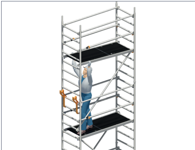
3. Diagonalen und Durchstiegsbrücke einsetzen.
