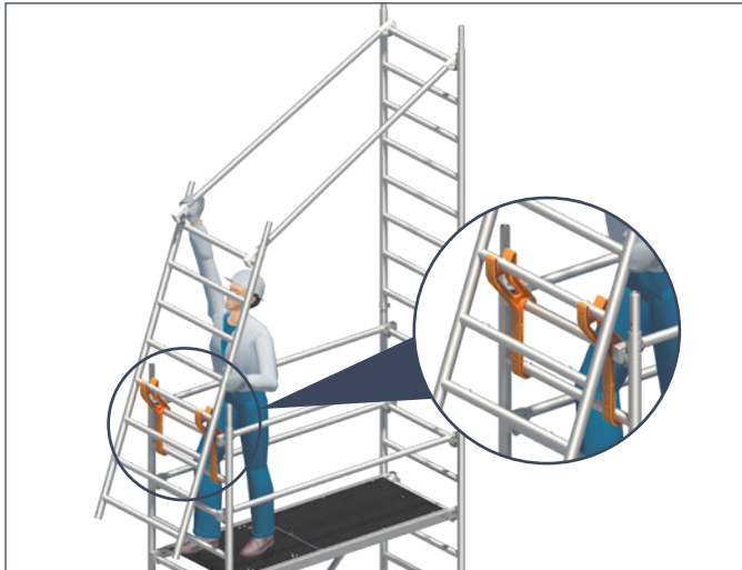
1. Aufstecken der ersten Standleiter. Anbringen der Uni Montagehaken und Positionierung der zweiten Standleiter zur Montage der Geländer.
